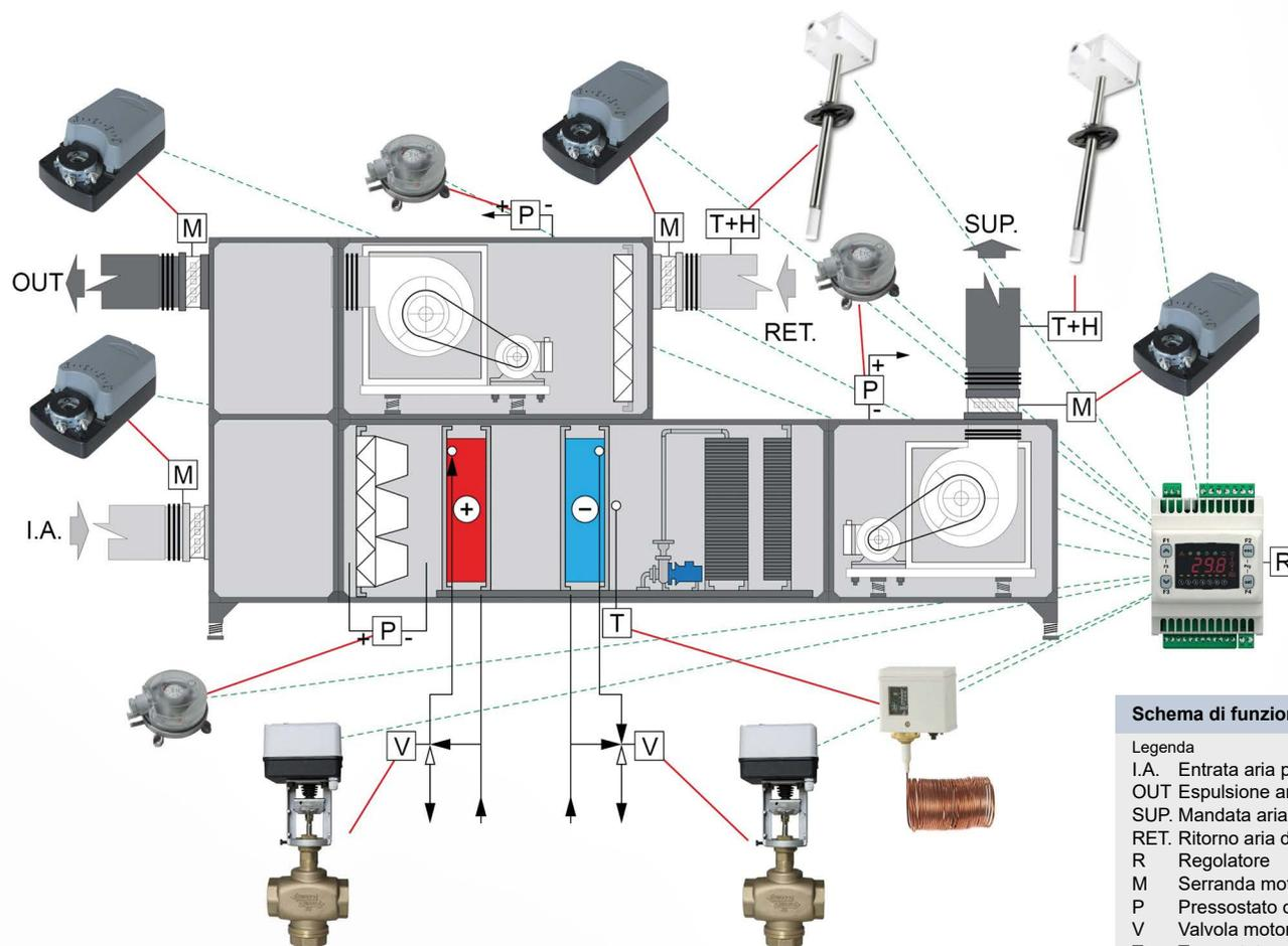
**Schema di funzionamento di un'unità di trattamento aria (UTA)**
